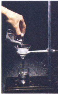
Gambar 1-3 Pemisahan campuran heterogen dengan cara penyaringan.
